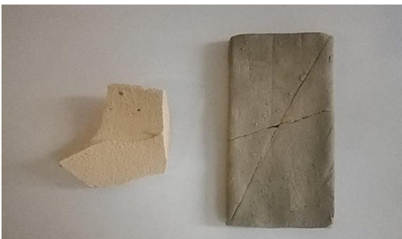
Fotografía 37. Cambios en la placa por acción de la temperatura. A la izquierda se observa placa secada naturalmente, a la derecha se observa placa secada por aumento de la temperatura.
