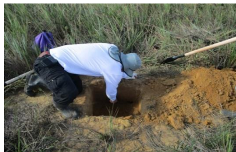
FOTO 16. REALIZACIÓN POZOS DE SONDEO TA5
