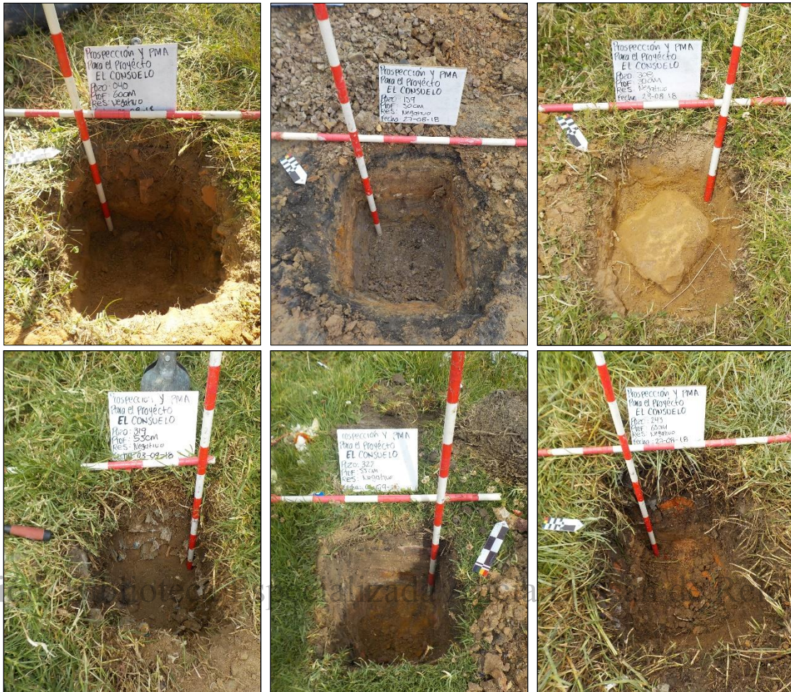
Fotografía 4-14 Pozos de sondeo con elevada intervención y suelos muy alterados
