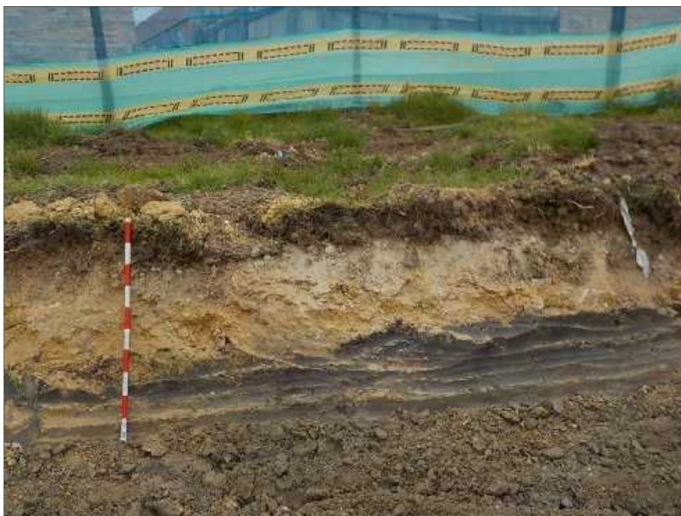
Foto 69. Perfil de excavación, profundidad 1 m. Presencia de recebo y material arcilloso
