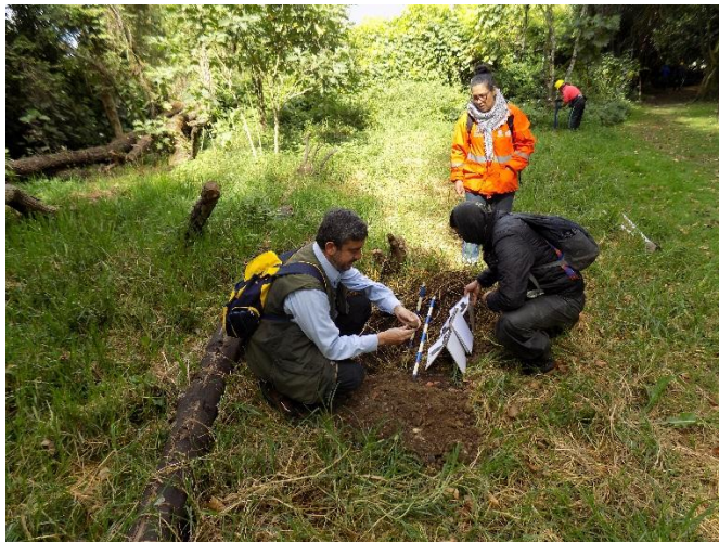
Fotografía 8. Revisión tierra y registro pozo de sondeo
