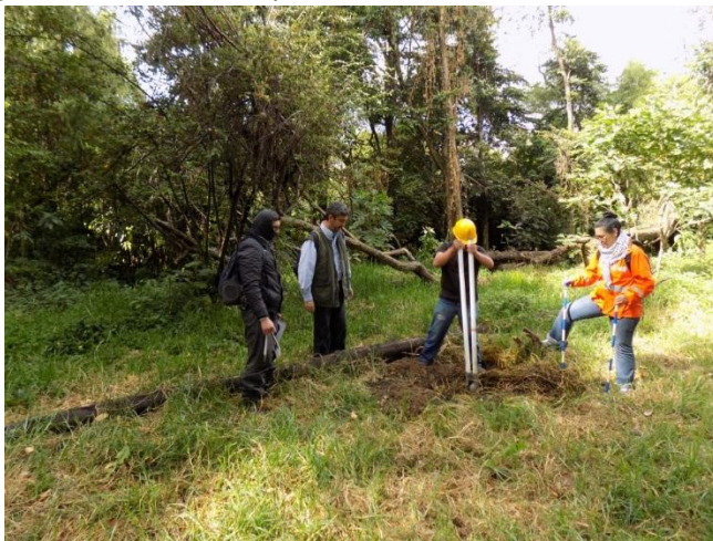
Fotografía 7. Realización pozo de sondeo lado norte del humedal
