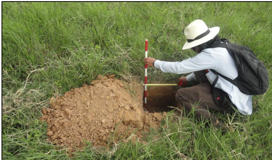
Foto 4. Toma de profundidad y datos estratigráficos.
