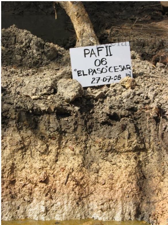
Ilustración 5. Perfil de suelos, río Calenturitas
