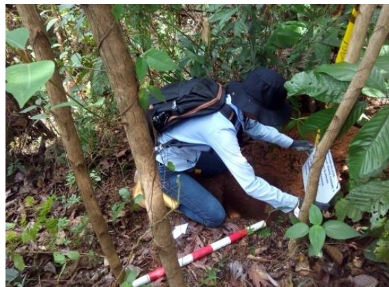
Fotografía 5 Registro de pozo de sondeo.
