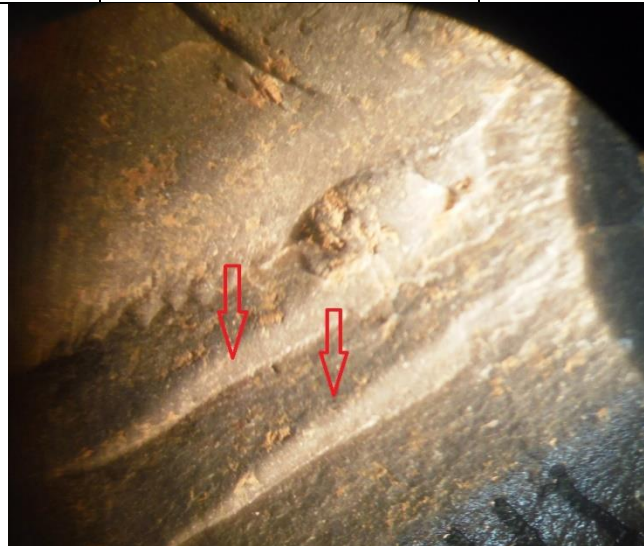
Foto 72 Líneas de fractura o de Wallner en desconchamiento al borde de herramienta.
