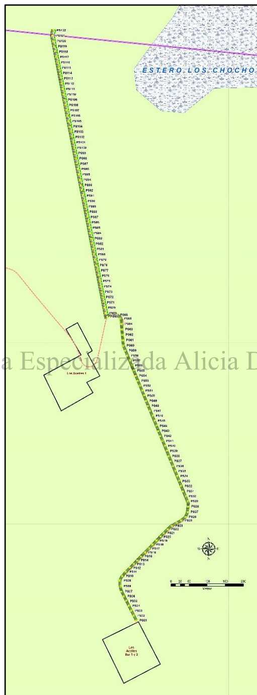
Figura 6. Establecimiento de los pozos de sondeo o unidades de muestreo en forma lineal cada 15 metros uno del otro sobre el trazado dispuesto para la Línea de Flujo entre Los Aceites Sur y el Oleoducto Los Toros-Gaván, Bloque Guachiría.
