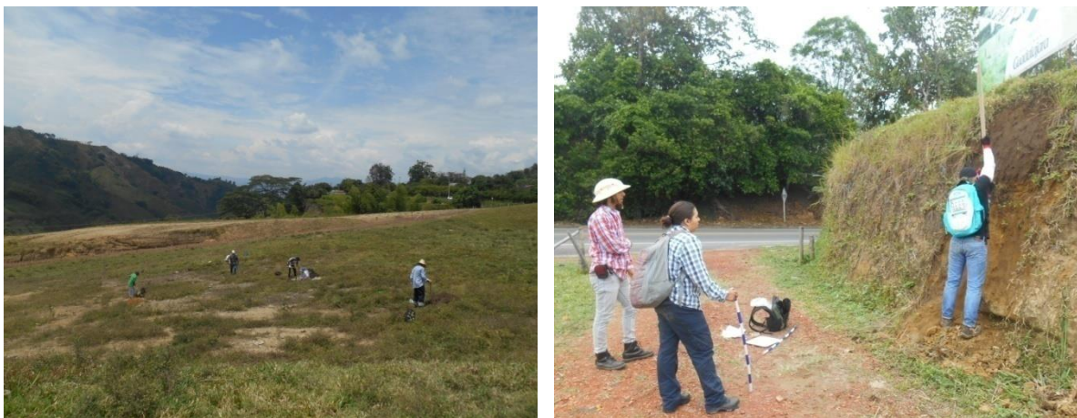
Fotos 8 y 9. Realización de pozos de sondeo y perfiles estratigráficos durante la prospección
