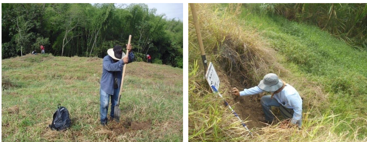
Fotos 23 y 24. Realización de pozos de sondeo y perfil estratigráfico en el SDFM
