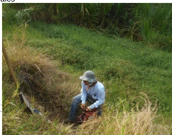
Fotos 6 y 7. Lectura de perfiles estratigráficos sobre taludes expuestos
