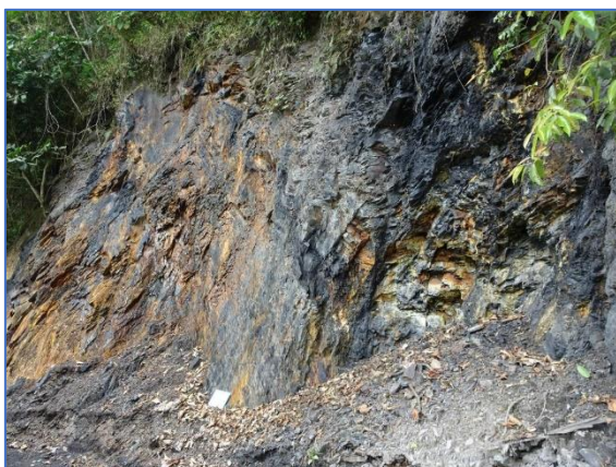
Fotos N°60 y 61. Roca con fracturas sobre la que se instalara la bocamina.
