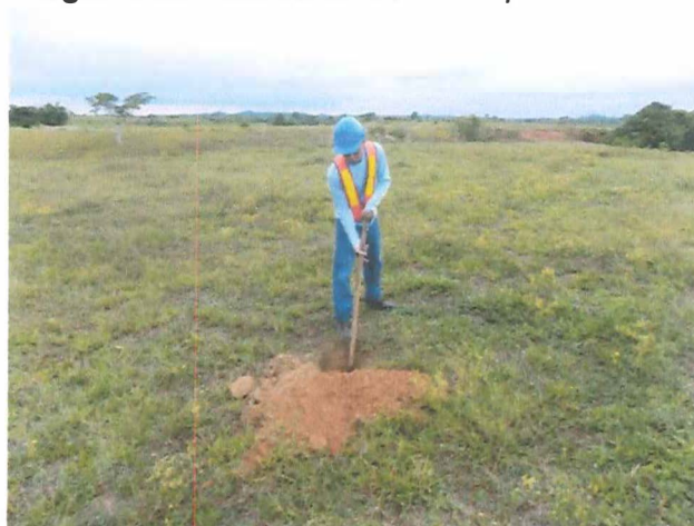
Fotografía 12. Panorámica realización pozo de sondeo
