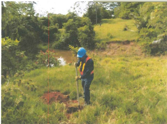
Fotografía 7. Panorámica realización pozo de sondeo cerca de jagüey
