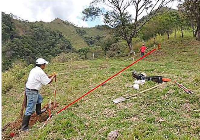
Foto 8. Líneas y pozos de sondeo en el área de influencia de la Central Hidroeléctrica de Los Andes, vereda El Maquencal, municipio de Planadas - Tolima
