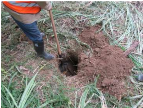
Foto 68 Sondeo que presenta suelos arenosos y presencia de escombros, en el delta de la quebrada Niquía.
