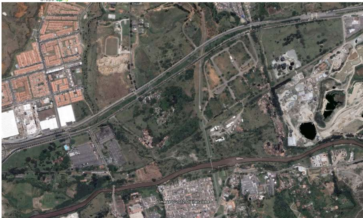
Figura 5 Área del proyecto con los límites y ubicación de las principales alteraciones como la Conducción de agua Niquía-Manantiales, la antigua vía férrea. Se distinguen los depósitos de escombros ubicados hacia ambos deltas de las quebradas y el cementerio de carros que ocupa el centro de la Terraza 1. Fuente: Google Earth Pro.
