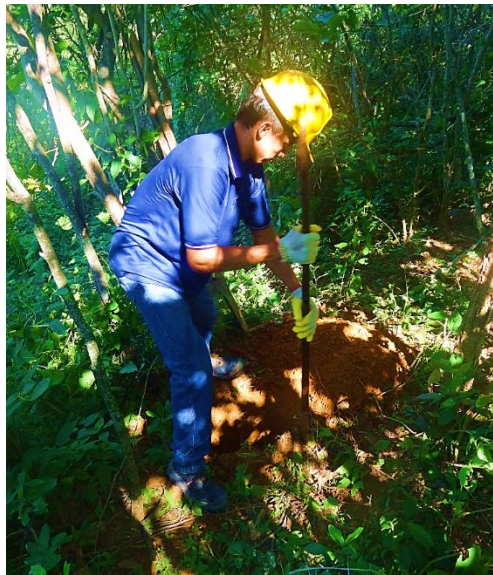
Fotografía 4. Realización de pozo de sondeo Área 2.
