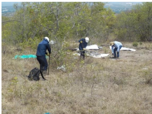
Fotografía 7 Realización de pozos de sondeo en el área central del predio
