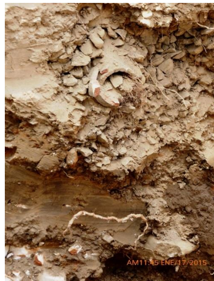
FOTO 7. RESTOS DE TUBERÍA DE BARRO DE DRENAJE Y TUBERÍAS DE PVC
