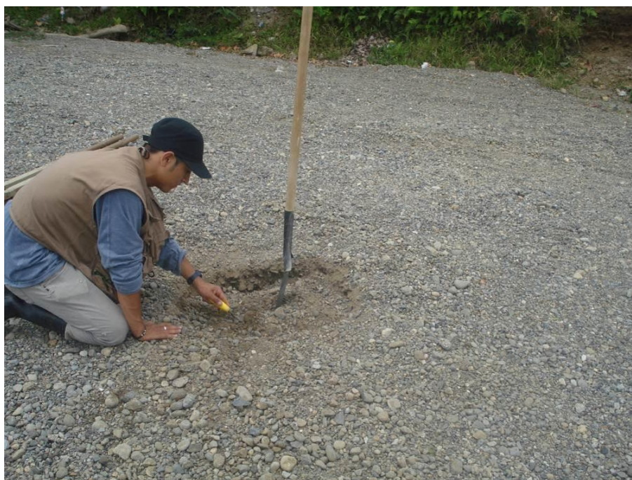
Fotografía 8. Desarrollo de pozos de sondeo durante la prospección en el río La Fortuna, Mutatá, Antioquia
