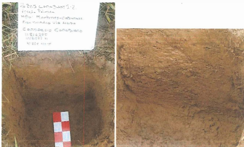
Fotos N° 11-12. Vista del pozo de sondeo 1, excavado en el trazado de la vía. Se observa en la imagen de la derecha un detalle del perfil donde se denota la humedad del lugar.
