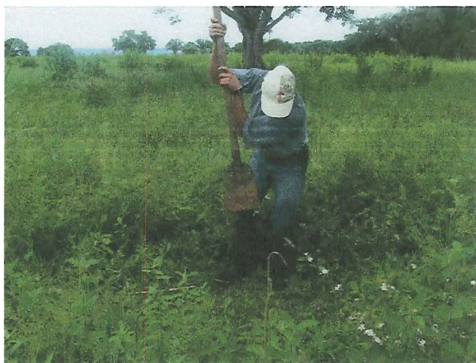
Foto N° 6. Proceso de excavación del pozo de sondeo N° 3.
