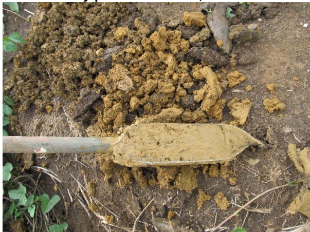
Foto 8. Prueba de barreno y pozo de sondeo, características del horizonte 1.
