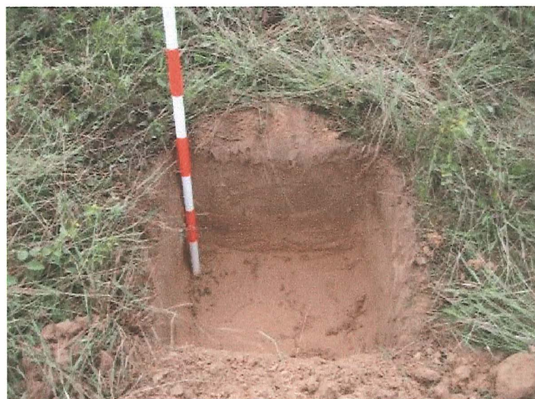
Foto 10. Detalle Pozo de Sondeo 5 (Solo muestra el Material parental)
