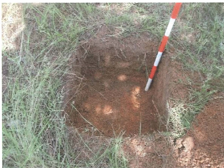
Foto 6. Detalle Pozo de Sondeo 1 (Solo muestra el Material parental)
