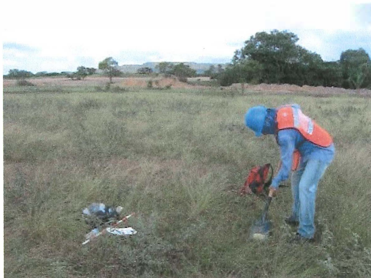
Foto 7. Pozo de Sondeo 2 Realizado en Paisaje de Sabana
