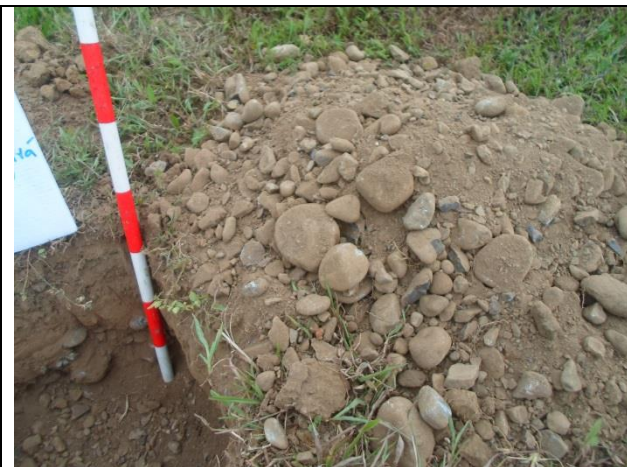
Foto 19. Tipo de materiales de los pozos de sondeo con grava. PS 1.
