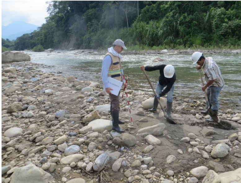
Fotografía 2. Realización pozos de sondeo
