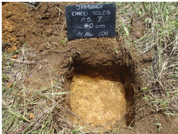
Foto 5. Pozo de sondeo 7. Se observa poca formación de suelos.
