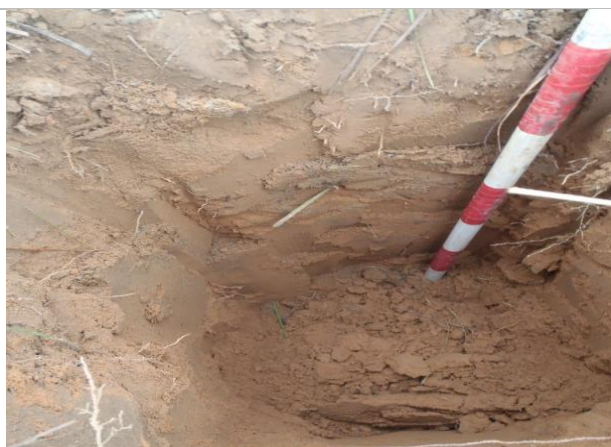
Fotografía 3. Perfil de un sondeo con la composición del suelo arenosa en una pequeña planicie en el área de estudio
