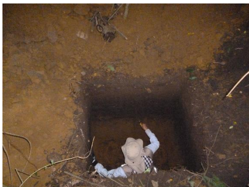
Foto 39. Labores de identificación y medición de espesores de los horizontes de suelo hallados en el perfil
