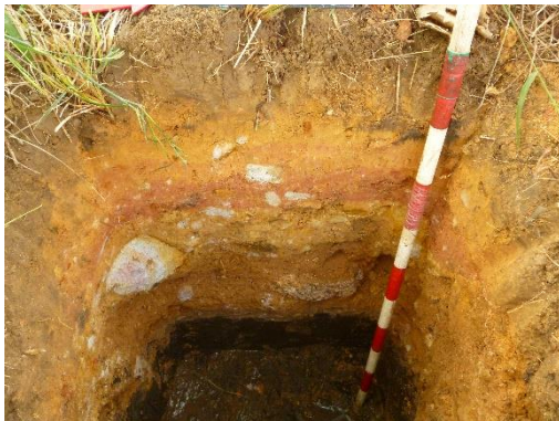
Foto 31. Perfil estratigráfico con roca meteorizada en sondeo PS45iE, abscisa K1+360.
