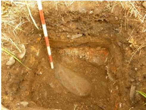
Foto 27. Perfil estratigráfico con material de río en sondeo PS47, abscisa K1+465.
