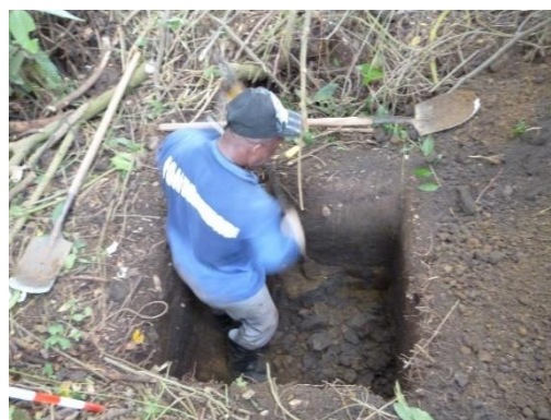
Foto 38. Ayudante de campo realizando excavación de pozo de control estratigráfico por niveles de 10 cm.
