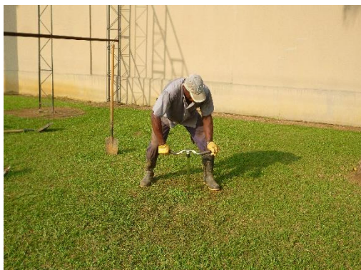
Foto 26. Realización de pruebas de barreno a 2.5m en dirección NW del sondeo PS54, abscisa K1+775.
