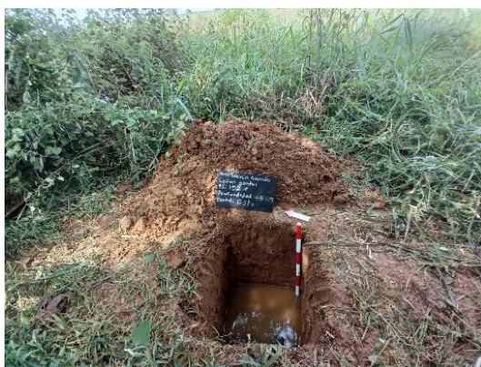
Foto 48. Sondeo PS152iE que alcanzó los 65 cm. de profundidad
