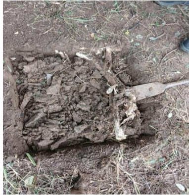
Foto 50. Excavación del PS105iE y la aparición de raíces que dificultaron su desarrollo Foto 51. Sondeo del PS106iO que alcanzó una profundidad de 75 cm. por la aparición de raíces
