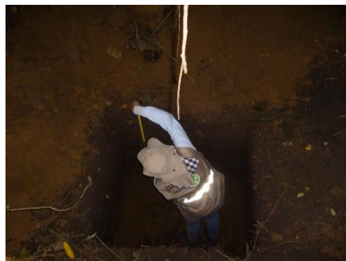
Foto 39. Labores de identificación y medición de espesores de los horizontes de suelo hallados en el perfil
