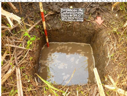
Foto 18. Nivel freático evidenciado en sondeo PS39iO, Abcisa K1+180
