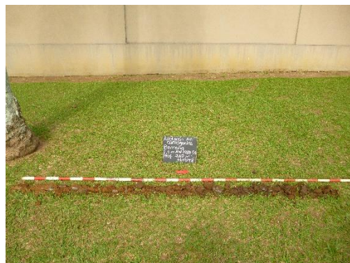
Foto 26. Realización de pruebas de barreno a 2.5m en dirección NW del sondeo PS54, abscisa K1+775.
