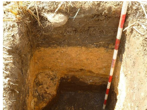
Foto 32. Perfil estratigráfico con arenilla y balastro en pozo PS72iE, abscisa K2+270.
