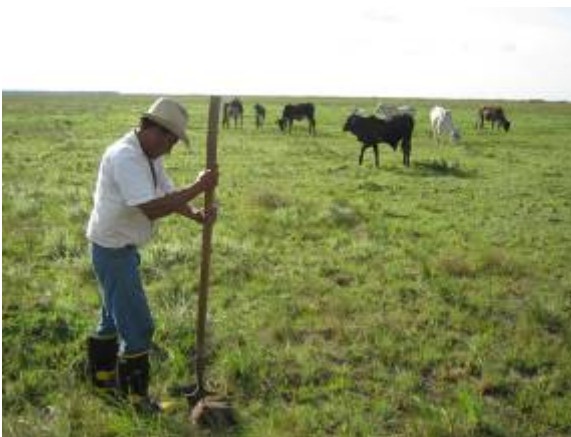
Foto 9: Prospección trazado vía. Apique 10. Coordenada: 904.759 E - 1.023.753 N
