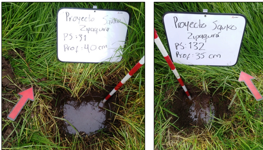
Fotografía 3. Nivel freático (aguas subterráneas) evidente en los pozos de sondeo llevados a cabo, proyecto Sauko Zipaquirá.
