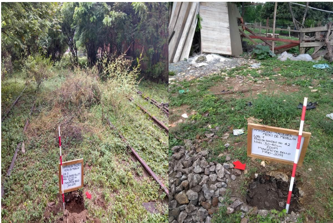
Fotos 90 y 91. Sondeos rotulados con tablero, jalón y norte para fotografía. En ambos pozos de sondeo se puede apreciar el balasto proveniente de las vías férreas disperso por el lote, y escombros recientes.
