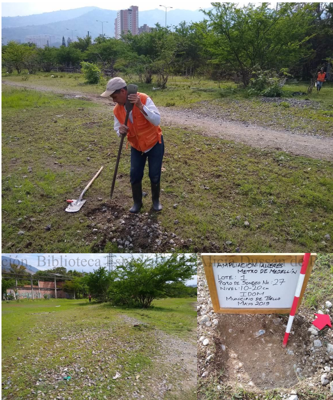
Fotos 108, 109 y 110. Suelos intervenidos por llenos antrópicos y con presencia de balasto proveniente de las vías férreas del antiguo Ferrocarril de Antioquia.
