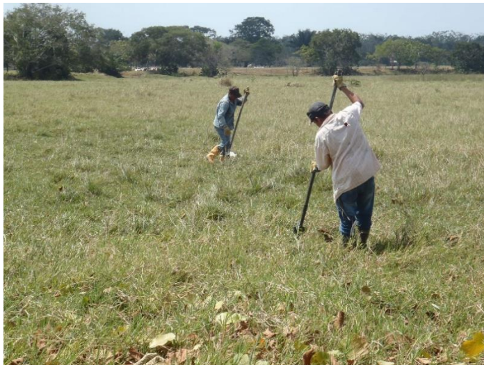
Fotografía 21. Realización de Pozos de sondeo en el área de estudio
