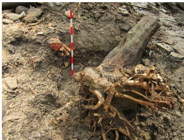
Foto 58. Perfil estratigráfico de 80 cm de profundidad evidenciado luego de actividades de excavación de árboles de laurel en el sector 1. Se puede ver que no presenta depósitos de suelo original, sino varias capas de llenos antrópicos compactados.
