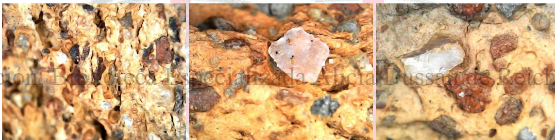
Fotografía 58 Vistas microscópicas de tres fragmentos cerámicos, con presencia de rocas grises y rojas, además de cuarzos como desgrasante
