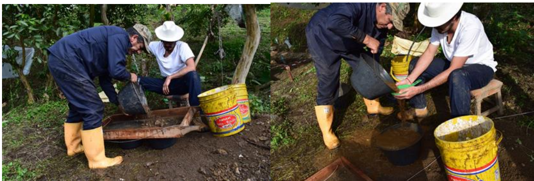
Fotografía 8 Proceso de tamizaje con ayuda de agua
