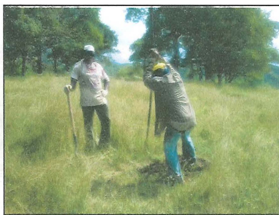
Fotos N°2 y 3. Excavación de pruebas de pala en los terrenos destinados a la explotación de gravilla. El Copey-Cesar.
