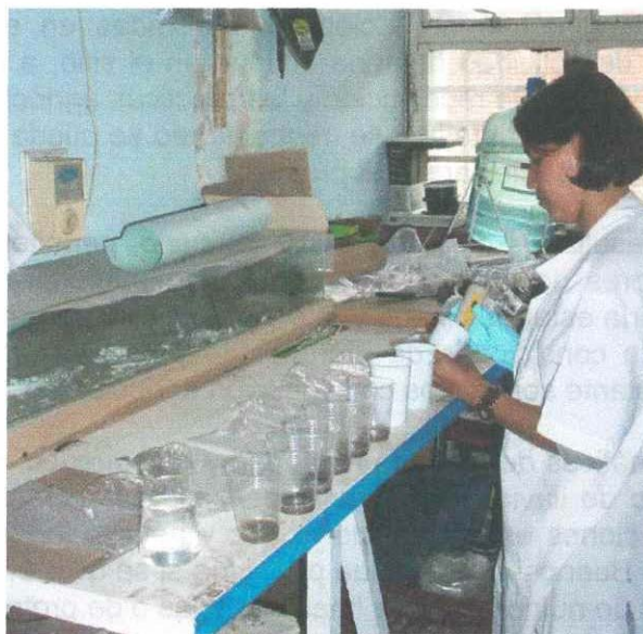
Foto 20. Trabajos de Laboratorio: Análisis de Suelos y Determinación de pH.
