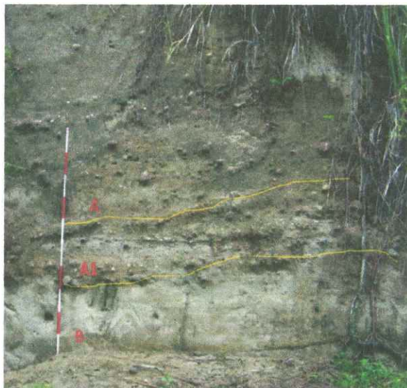
Foto 9. Horizontes Estratigráficos del Perfil 3. Se observa en Estrato B la Cinta de Toba Volcánica
